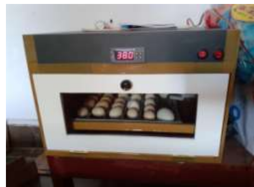
Gambar 2. Rancangan Sistem Kontrol Pada Suhu 38°C
