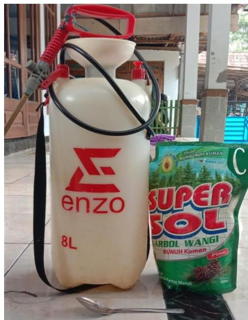
Gambar 3. Alat Sederhana yang Digunakan untuk Penyemprotan Disinfektan
